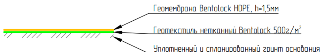
Рисунок 38. Конструкция дна пруда-накопителя для грязных поверхностных вод
