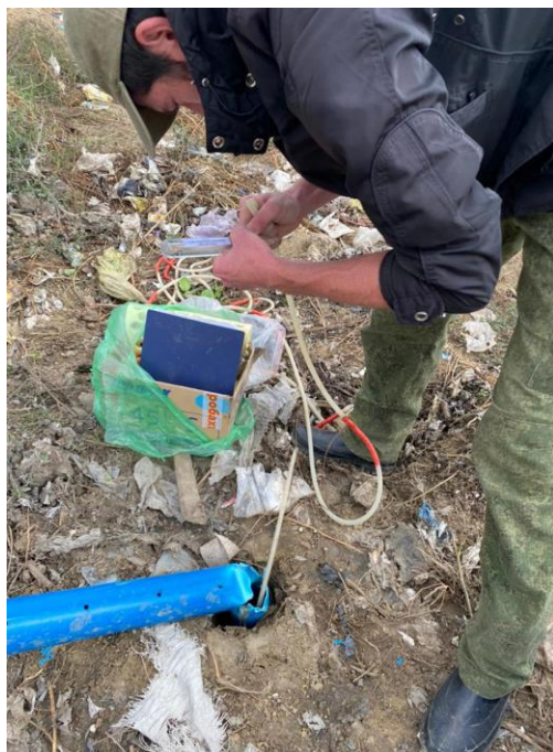
Рисунок 17. Отбор проб при проведении глубинных газогеохимических исследований
