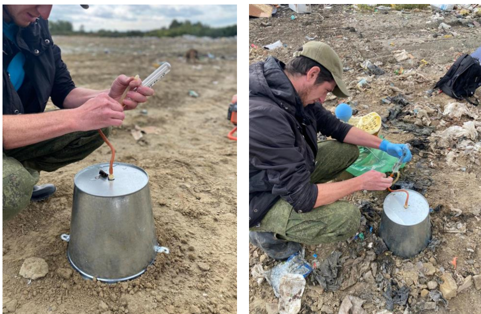
Рисунок 10. Отбор проб при проведении эмиссионной съёмки
