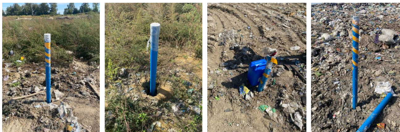
Рисунок 15. Геологические скважины, обсаженные перфорированной трубой до проведения газогеохимических исследований
