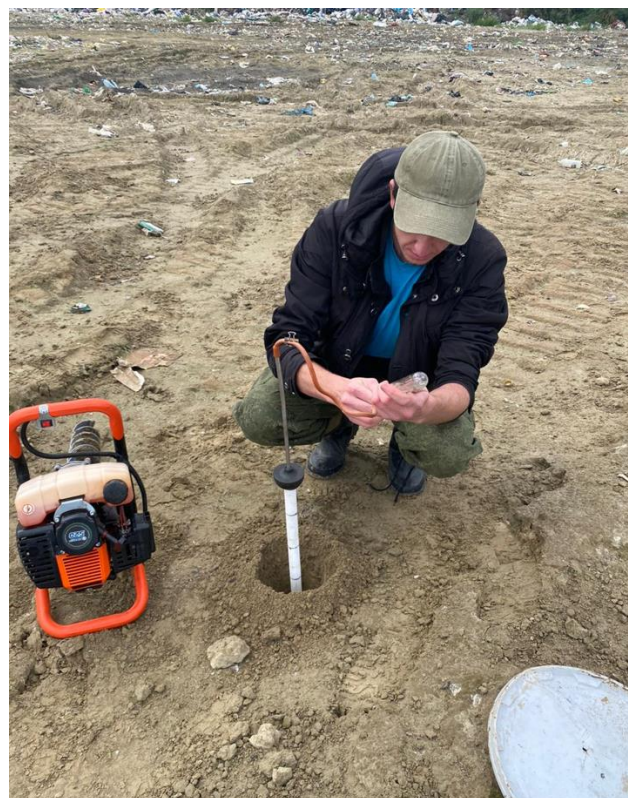
Рисунок 5. Отбор проб при проведении шпуровой съемки
