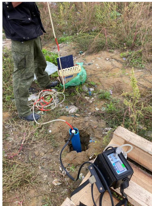
Рисунок 17. Отбор проб при проведении глубинных газогеохимических исследований
