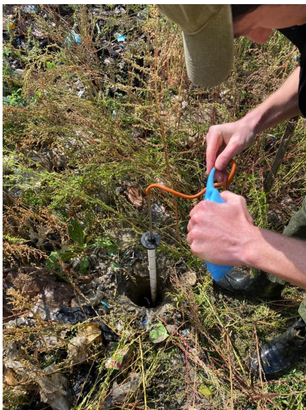
Рисунок 5. Отбор проб при проведении шпуровой съемки
